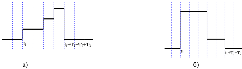
Рисунок 3 – Можливі варіанти монотонної ЛЧФ: а) зростаюча ЛЧФ, б) спадна ЛЧФ
